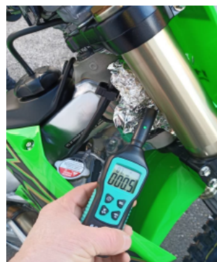
Champ électromagnétique mesuré en bas à droite de la fourche, CDI couvert d'une feuille d'aluminium: 0.5 mG (2.4 mG sans feuille aluminium)
