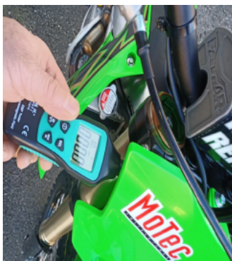
Champ électromagnétique mesuré en haut à droite de la fourche: 0.0 mG
