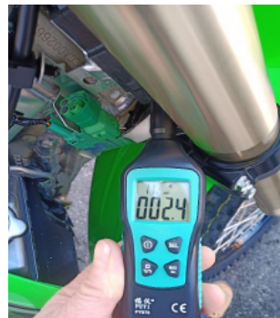
Champ électromagnétique mesuré en bas à droite de la fourche: 2.4 mG
