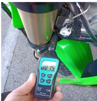
Champ électromagnétique mesuré en bas à gauche de la fourche: 1.5 mG (milli Gauss)
